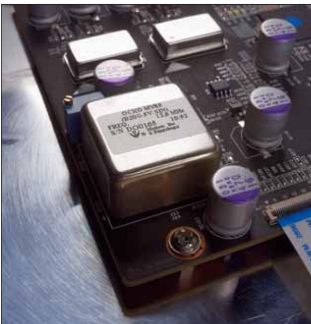
Der „Oven“-Clock gibt einen weitaus stabileren Takt raus als herkömmliche Taktgeber
