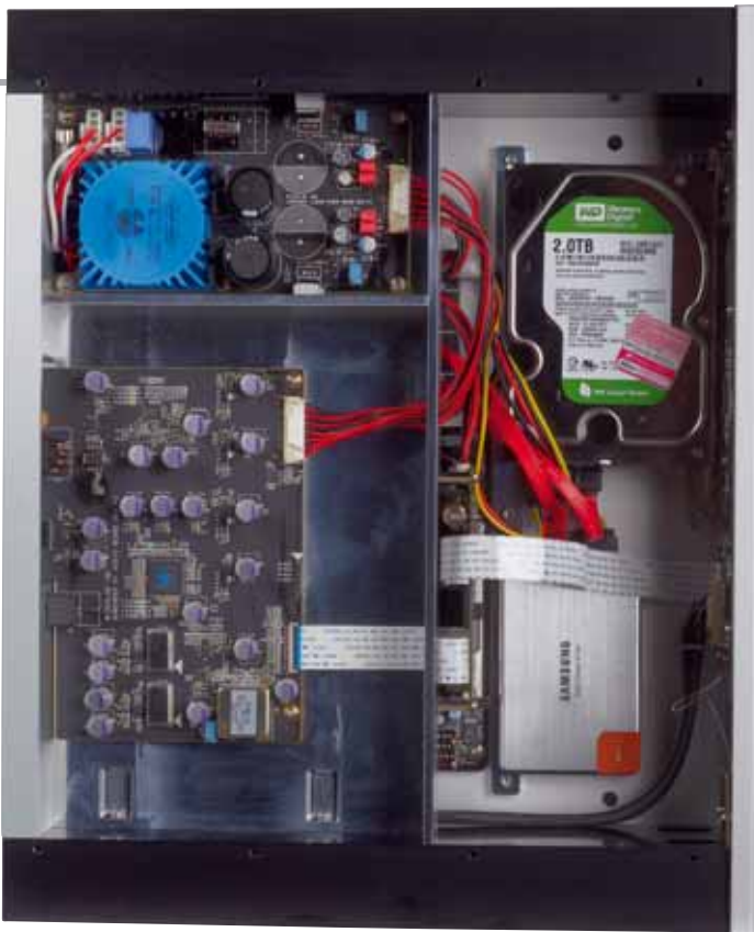
In voneinander abgeschirmten Kammern sitzen Festplatten, Stromversorgung und das „Digitalboard“. Der Prozessor ist eine Etage tiefer
